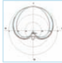
Rode NT 5: Die Frequenzgangkurve beginnt bei 50 Hz circa 8 dB unter ihrem sonst recht geraden Verlauf ab etwa 200 Hz. Die Ausnahme ist eine Einbuchtung bei 9 kHz. Das Richtdiagramm entspricht dem einer breiten Niere.
