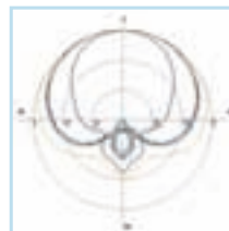
T.bone SC 100MkII: Hier zeigt sich ein unruhiger Frequenzgang mit einem Maximum bei 700 Hz. Ein weiterer Anstieg ist zwischen 4 und 10 kHz. Die Richtcharakteristik schwankt bei den einzelnen Frequenzen zwischen breiter Niere und Hyperniere. Verfärbungen des Umgebungsschalls sind damit programmiert.
