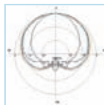
Microtech Gefell M 300: Der Frequenzgang steigt moderat bis zu Frequenzen von 8 kHz. Hier befindet sich ein Maximum. Danach fällt er schnell bis 20 kHz um rund 14 dB. Im Polardiagramm ist zu erkennen, dass bei 8 kHz die Charakteristik der einer breiten Niere entspricht.
