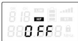
Appuyez sur **[SET]** à plusieurs reprises jusqu'à ce que « **ON** » ou « **OFF** » et le champ « **HF** » clignotent à l'écran. Utilisez les touches ▲ ou ▼ pour activer ou désactiver l'accentuation des hautes fréquences (affichage « **ON** » ou « **OFF** »). Si la fonction est activée, les fréquences sont accentuées de 6 dB à partir de 10 kHz et le champ « **HF** » s'affiche à l'écran. Aucune accentuation n'a lieu si la fonction est désactivée.
