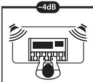
Wenn die Monitore wie in Abbildung A dargestellt in der Nähe einer Raumecke aufgestellt werden, stellen Sie den Schalter Acoustic Space zunächst auf -4 dB, was für eine maximale Bassdämpfung sorgt.
