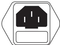
**IEC-Netzbuchse:** Ihr Eris E5/E8 bietet eine Buchse zum Anschluss eines Standard IEC-Netzkabels.
