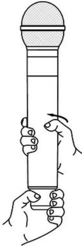
Das Batteriefach des UHF-Handsenders befindet sich unter der Griffhülse und teilt sich mit der Mikrofonkapsel das gleiche Gewinde. Um an das Batteriefach zu gelangen und nicht versehentlich die Mikrofonkapsel abzuschrauben, halten Sie den UHF-Handsender unten am Antennenansatz fest und drehen die Hülse wie abgebildet. Nach dem Batteriewechsel schießen Sie das Gehäuse wieder. Achten Sie darauf, die Griffhülse nicht zu fest anzuziehen.
