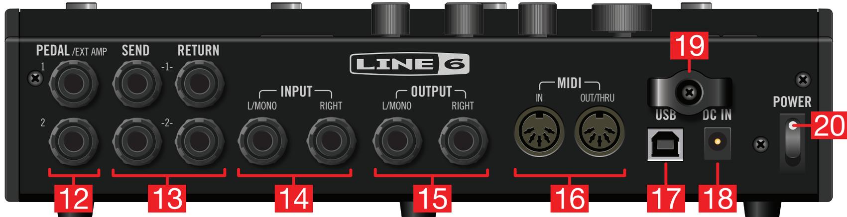
**12. PEDAL/EXT AMP 1&2:** Bei Bedarf können Sie zwei Expression-Pedale an den HX Effects anschließen, um die gewünschten Parameter zu beeinflussen. Anfangs dient EXP 1 für die Nutzung und Deaktivierung von Wah/Pitch Wham-Blöcken und EXP 2 für die Steuerung von Volume-Blöcken. Siehe ["Zuordnen eines Controllers"](#).
