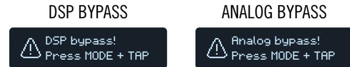
**Anmerkung:** Der HX Effects unterstützt zwei "All Bypass"-Optionen: "Analog bypass" (wird auch oft "True Bypass" genannt), wobei mechanische Relais das eingehende Signal direkt –und ohne A/D/A-Wandlungen– an die Ausgänge anlegen, und "DSP bypass", bei dem Delay-Wiederholungen und Hallfahnen natürlich abklingen. Laut Vorgabe verwendet der HX Effects das "Analog bypass"-Verfahren.
