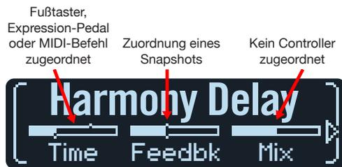
**Anmerkung:** Wenn Sie einen Wah- oder Pitch Wham-Block einfügen, wird er automatisch "EXP 1" zugeordnet. Wenn Sie einen Volume Pedal- oder Pan-Block einfügen, wird er automatisch "EXP 2" zugeordnet.
