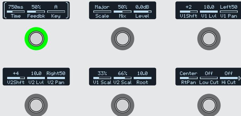
Berühren Sie den gewünschten Fußtaster, um seine Parameter zu wählen und stellen Sie sie mit den Reglern 1~3 ein. Wenn ein Block mehr als 18 Parameter enthält, können Sie mit > zu den übrigen Parametern gehen. Halten Sie schließlich einen Fußtaster 1 Sekunde gedrückt (oder drücken Sie ↵), um diese Seite zu verlassen.
