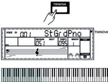
Im Modus TWINOVA wird die Tastatur in zwei Bereiche mit derselben Stimme und derselben Tonhöhe unterteilt.
