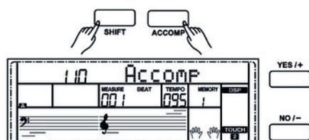
1. ▶ Drücken Sie gleichzeitig die Tasten *[SHIFT]* und *[ACCOMP]*. Das Display zeigt die aktuelle Lautstärkeeinstellung der Begleitspur an.
