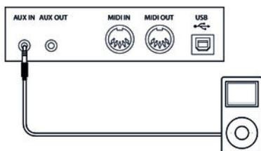
Über die Buchse [AUX IN] können Sie z. B. einen CD- oder MP3-Player an das Digitalpiano anschließen. Damit können Sie Musikstücke über die internen Lautsprecher des Digitalpianos wiedergeben und gleichzeitig dazu spielen. Stecken Sie ein Ende des Audiokabels in die Buchse [AUX IN] auf der Rückseite des Digitalpianos und das andere Ende in den Ausgang des entsprechenden Audiogeräts.
