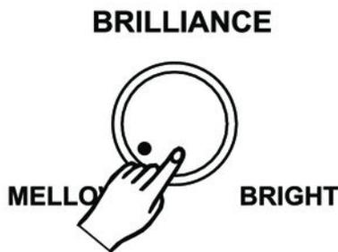
Mit dem Drehregler *[BRILLIANCE]* können Sie die Klanghelligkeit des Digitalpianos einstellen. Der Klang wird für den gesamten Tastaturbereich weicher und dunkler, wenn Sie den Regler nach links drehen und heller und brillanter, wenn Sie den Regler nach rechts drehen.
