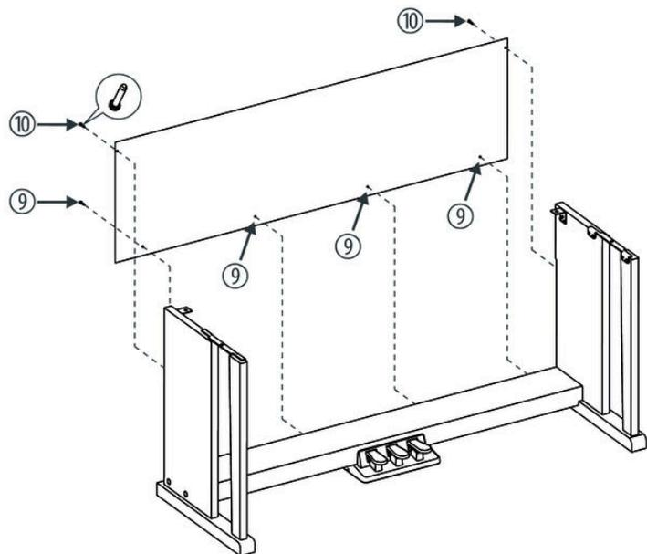
4. ➤ Befestigen Sie die Rückwand mit vier Schrauben M4 × 15 und zwei Schrauben M6 × 12 am Pedalkasten und an den Rückseiten der Seitenteile.
