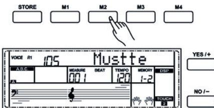
1. ➤ Halten Sie die Taste [STORE] gedrückt und drücken Sie gleichzeitig eine der Tasten [M1] bis [M4]. Die aktuellen Einstellungen werden dann in dem jeweiligen Speicherplatz (M1 bis M4) abgelegt. Bitte beachten Sie, dass dabei zuvor dort gespeicherte Daten gelöscht werden.
