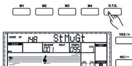
One Touch Setting (O.T.S. oder Ein-Tasten-Bedienung) ist eine komfortable Funktion, die Ihnen das sofortige Umkonfigurieren aller Einstellungen mit nur einem einzigen Tastendruck ermöglicht. Dabei handelt es sich um rhythmusbezogene Zusammenstellungen von Instrumentenstimmungen. Mit dieser Funktion können vier Parameter-typen (M1 bis M4) geladen werden.
