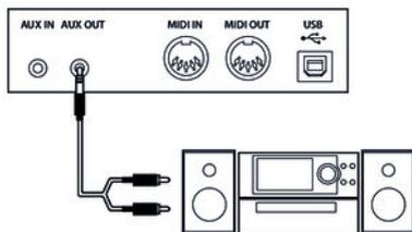
Über die Buchse [AUX OUT] können Sie das Digitalpiano an einen Verstärker, eine Stereoanlage, ein Mischpult oder ein Aufnahmegerät anschließen. Stecken Sie ein Ende des Audiokabels in die Buchse [AUX OUT] auf der Rückseite des Digitalpianos und das andere Ende in den Eingang des entsprechenden Audiogeräts.
