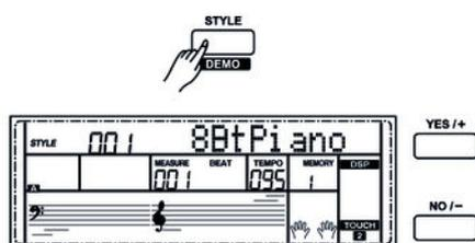
1. Drücken Sie die Taste *[STYLE]* oder eine der Direktwahltasten im Bereich *[STYLES]*, um den Modus STYLE zu aktivieren. Die Anzeige „STYLE“ leuchtet dann im Display. Die Nummer und der Name des aktuellen Styles erscheinen im Display.
