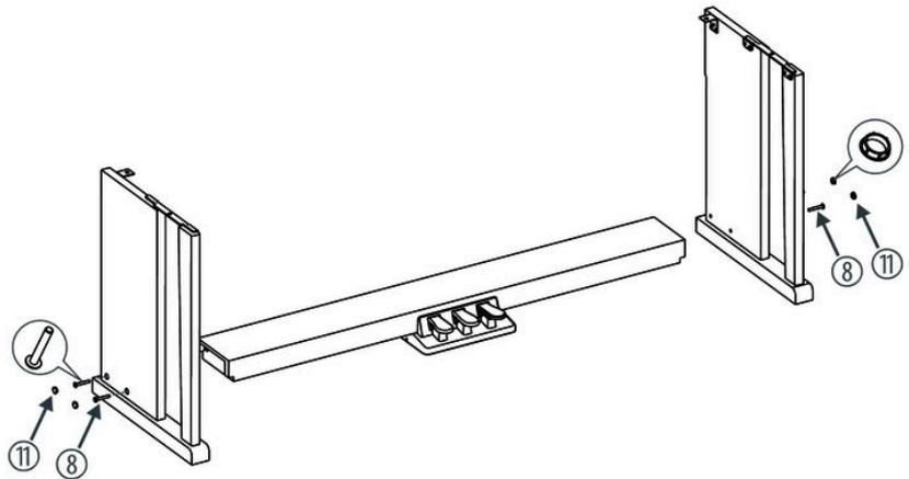
3. ➤ Stellen Sie den Pedalkasten zwischen das linke und das rechte Seitenteil und verwenden Sie jeweils zwei Schrauben M6 × 40 auf jeder Seite, um die beiden Seitenteile am Pedalkasten zu befestigen.
