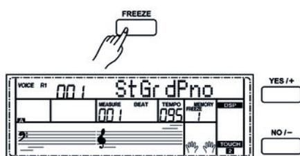
1. ➤ Drücken Sie die Taste *[FREEZE]*, um die Sperrfunktion zu aktivieren. Die Anzeige „FREEZE“ leuchtet im Display auf.
