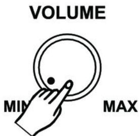
Stellen Sie mit dem Drehregler *[VOLUME]* eine für die Wiedergabe und das Üben angenehme Lautstärke ein. Drehen Sie den Regler im Uhrzeigersinn, um die Lautstärke zu erhöhen. Drehen Sie ihn entgegengesetzt, um die Lautstärke zu verringern.
