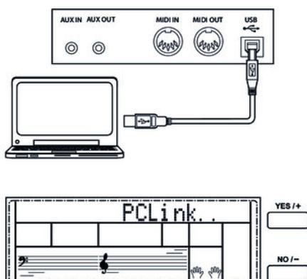
Starten Sie zunächst Ihren Computer. Verbinden Sie den USB-Anschluss auf der Rückseite des Digitalpianos über ein Standard-USB-Kabel (nicht im Lieferumfang enthalten) mit dem USB-Anschluss an Ihrem Computer. Schalten Sie anschließend das Digitalpiano ein.
