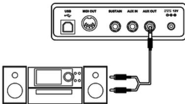
Über die Buchse [AUX OUT] können Sie das Digitalpiano an einen Verstärker, eine Stereoanlage, ein Mischpult oder ein Aufnahmegerät anschließen. Stecken Sie ein Ende des Audiokabels in die Buchse [AUX OUT] auf der Rückseite des Digitalpianos und das andere Ende in den Eingang des entsprechenden Audiogeräts.
