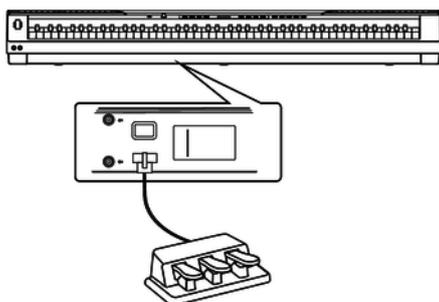
Über die Anschlussbuchse auf der Unterseite des Digitalpianos können Sie das Dreifach-Pedal (Sustain, Sostenuto und Soft) des optionalen Thomann Originalständers (Artnr. 352262) anschließen.
