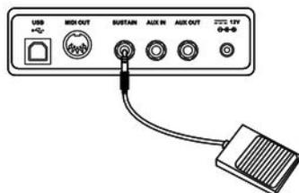
Über die Anschlussbuchse [SUSTAIN] können Sie ein Sustain-Pedal an das Digitalpiano anschließen.
