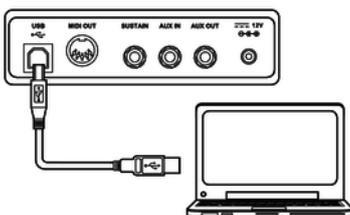
Über den USB-Anschluss können Sie das Digitalpiano zum Austausch von Daten mit einem PC verbinden.
