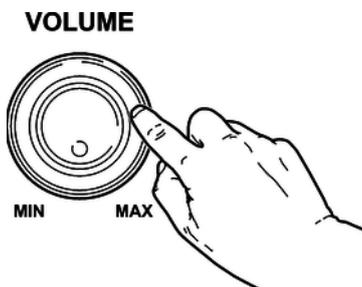
Stellen Sie mit dem Drehregler *[VOLUME]* eine für die Wiedergabe und das Üben angenehme Lautstärke ein. Drehen Sie den Regler im Uhrzeigersinn, um die Lautstärke zu erhöhen. Drehen Sie ihn entgegengesetzt, um die Lautstärke zu verringern.
