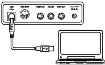
1. ➤ Verbinden Sie den USB-Anschluss des Digitalpianos über ein Standard-USB-Kabel (nicht im Lieferumfang enthalten) mit dem USB-Anschluss an Ihrem Computer.
