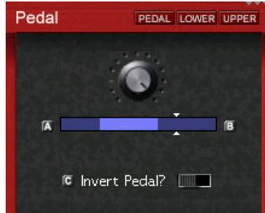
Mit den Endlospotis A und B kann der Minimum- und der Maximumwert eingestellt werden. Der Pfeil am Balken zeigt die aktuelle Position des Pedals an. Mit dem Endlospoti C kann die Funktion des Pedals invertiert werden.
