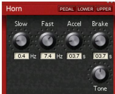
Hier können Sie diverse Parameter der Rotor-Emulation einstellen. Viele Rotor-Anlagen hatten Lautsprecher für Bässe (Bass) und ein Horn für die Höhen (Treble), die unterschiedlich rotierten und deren Verhalten bei der B4000+ getrennt geregelt werden kann.
