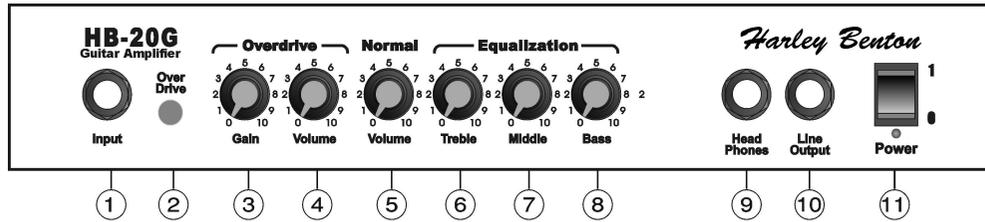
1. Input: 6,3mm Klinkenbuchse zum Anschluss von Gitarre, Bass, Keyboard, CD-Player, usw.
