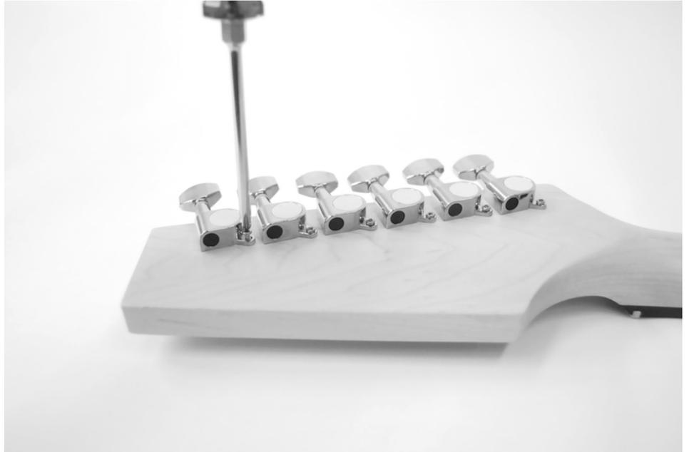
Retournez le manche et fixez tous les mécanismes d'accordage à la main sur la face avant de la tête à l'aide des rondelles et des écrous fournis.
