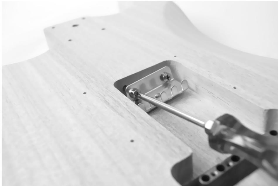
Fixez les œillets des trois ressorts sur la plaque à ressort et insérez l'autre extrémité dans les petits trous dans le bloc sustain. Serrez les vis de la tôle élastique dans la direction du cou jusqu'à ce que l'entretoise soit sous tension suffisante.
