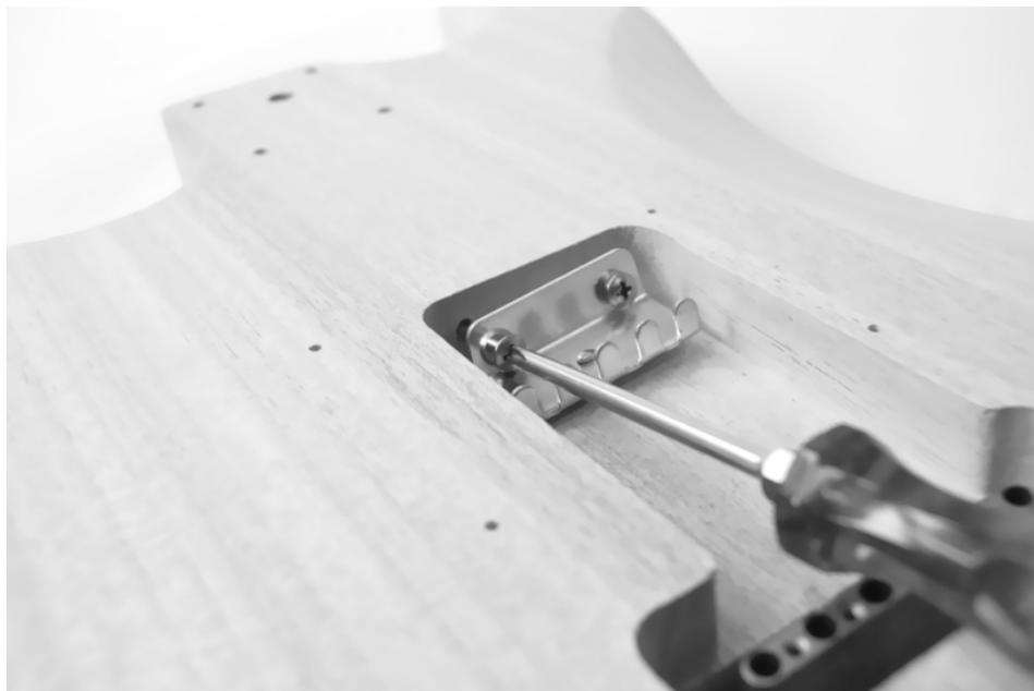
Sujete los ganchos de los tres muelles en la chapa de sujeción e introduzca los otros extremos en los orificios pequeños del bloque de sostenimiento. Apriete los tornillos de la chapa de sujeción de los muelles en la dirección del mástil hasta que la tensión del puente sea la adecuada.
