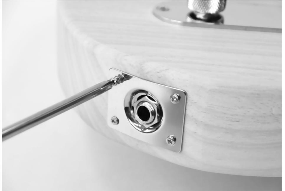
Atornille la placa del potenciómetro al cuerpo con los tornillos suministrados.
