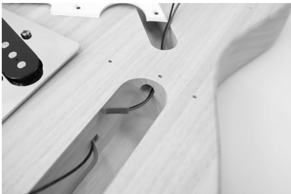
Coloque el protector sobre la parte frontal del cuerpo de forma que las pastillas del mástil queden situadas correctamente en la ranura. Atornille el protector al cuerpo con los tornillos suministrados.
