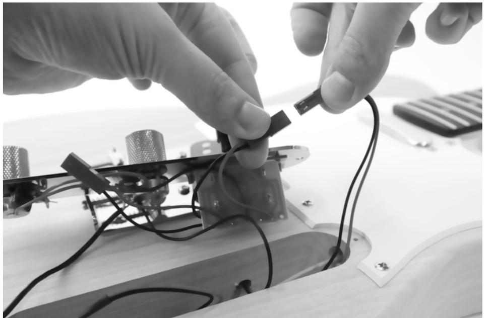
Inserte el soporte para el terminal de conexión y controle el extremo saliente del terminal. Este debe sobresalir lo suficiente como para poder atornillarlo con la tuerca suministrada, pero solo debe sobresalir lo mínimo. Dado el caso, corrija el extremo saliente, girando la contratuerca por del interior.
