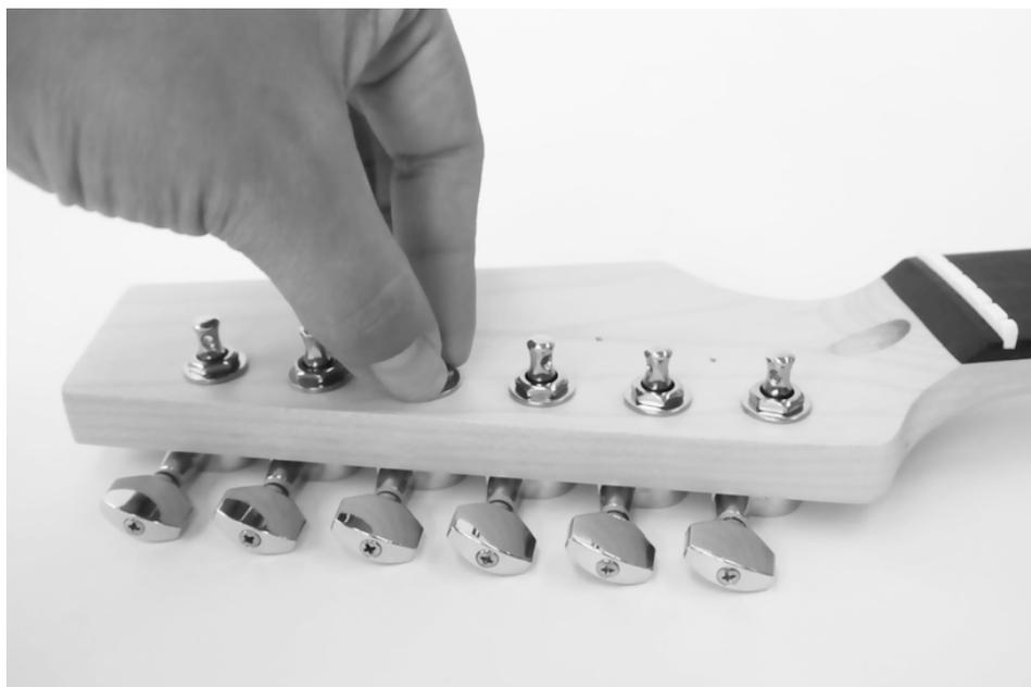
Apriete las tuercas en la parte delantera con una llave adecuada y, a continuación, apriete los tornillos para fijar las clavijas en la parte posterior.
