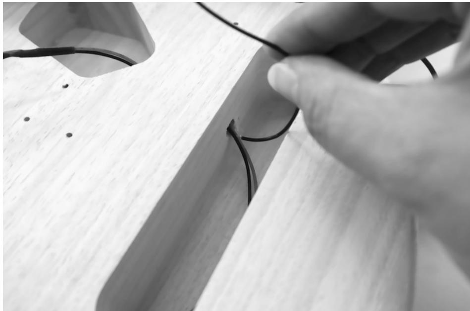
A continuación, saque el cable del agujero lo suficiente como para que durante el montaje del puente se pueda producir un contacto suficiente con la superficie metálica. La conexión a tierra de las cuerdas es necesaria para minimizar posibles interferencias.
