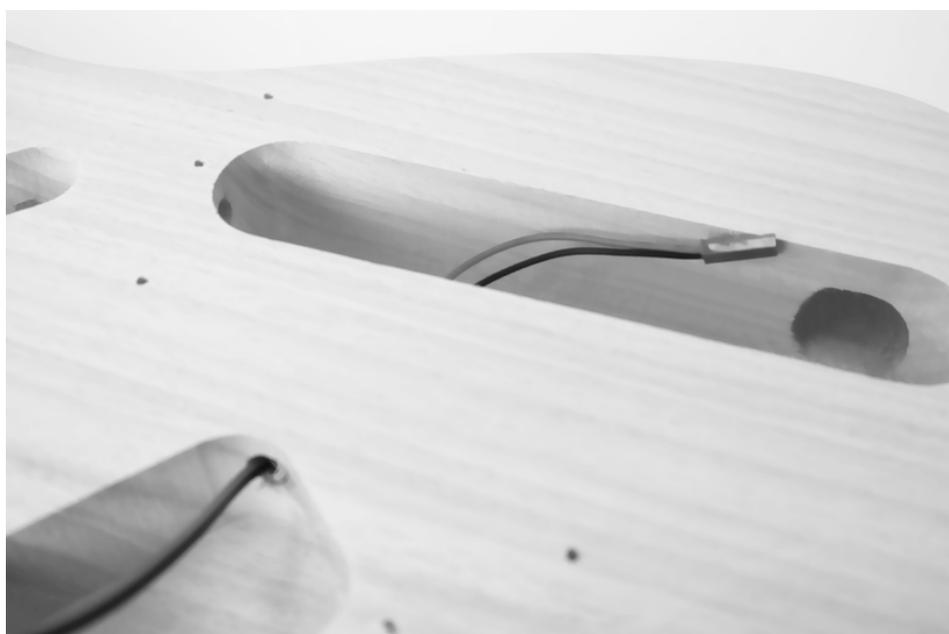
Tienda el cable de puesta a tierra (desaislado, sin conector) por el canal en la ranura para la placa del potenciómetro hasta la ranura para las pastillas del puente.
