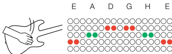
Schlagen Sie die Saiten Ihrer Gitarre durch. Korrekt gestimmte Saiten werden im Display durch zwei grüne LEDs dargestellt. Saiten, die gestimmt werden müssen, werden mit zwei roten LEDs unter (Saite zu tief gestimmt) oder über (Saite zu hoch gestimmt) der mittleren LED-Reihe hervorgehoben.
