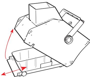
Gehäuse nach oben klappen. Fluidbehälter vorsichtig nach vorne herausnehmen. Befüllen und vorsichtig ins Geräteinnere zurückstellen. Stellen Sie sicher, dass Sie den Tankbehälter korrekt einfügen. Mit senkrechter Kantenwand ins Geräteinnere, wie auf der Zeichnung dargestellt. Gehäuse schließen.
