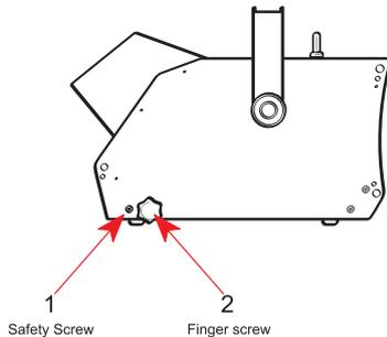
Schrauben rechts und links vom Gerät mit Schraubendreher aufdrehen (siehe Zeichnung, 1).
