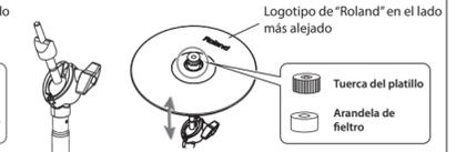
Apriete la tuerca del platillo lo suficiente para que haya un grado de oscilación adecuado. Use la tuerca del platillo y el disco de fieltro que se incluyen con el soporte.
