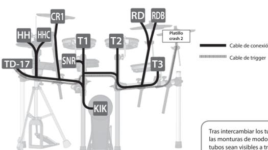
Usando el cable de trigger incluido, conecte el platillo crash 2 al conector CRASH 2 del TD.
