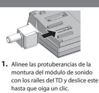
1. Alinee las protuberancias de la montura del módulo de sonido con los riles del TD y deslice este hasta que oiga un clic.
