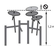
Acople el platillo de modo que su centro no sobrepase los tubos del soporte (los tubos de la parte trasera del soporte).
