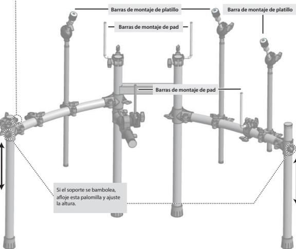
Si el soporte se bambolea, afloje esta palomilla y ajuste la altura.
