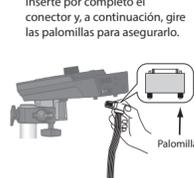
2. Cada cable lleva una etiqueta que indica a qué pad debe conectarse. Conecte el cable al conector OUTPUT de cada pad, como se muestra en la ilustración.
