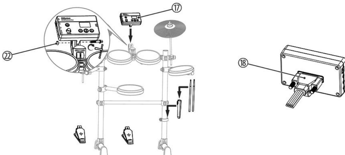
1. Setzen Sie das e-drum-Modul (17) auf Anschlag in die freie Halterung des waagrechten Verbindungsrohrs (6).
