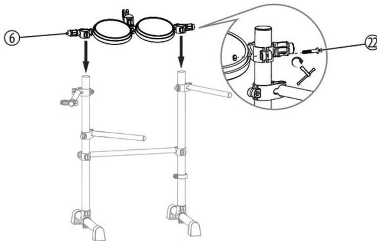
1. Befestigen Sie das waagrechte Verbindungsrohr (6) an den seitlichen Stützrohren (2, 3).
