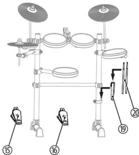
1. Hängen Sie die Drumstick-Halterung (19) in die vorgesehene Schiene am seitlichen Stützrohr (3) ein und verstauen Sie die Drumsticks (20) in der Drumstick-Halterung.
