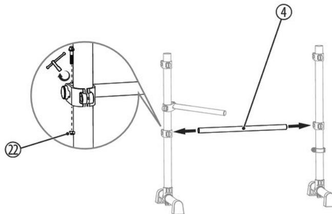
1. Befestigen Sie das waagrechte Verbindungsrohr (4) in den vorgesehenen Befestigungsklemmen der seitlichen Stützrohre (2, 3).
