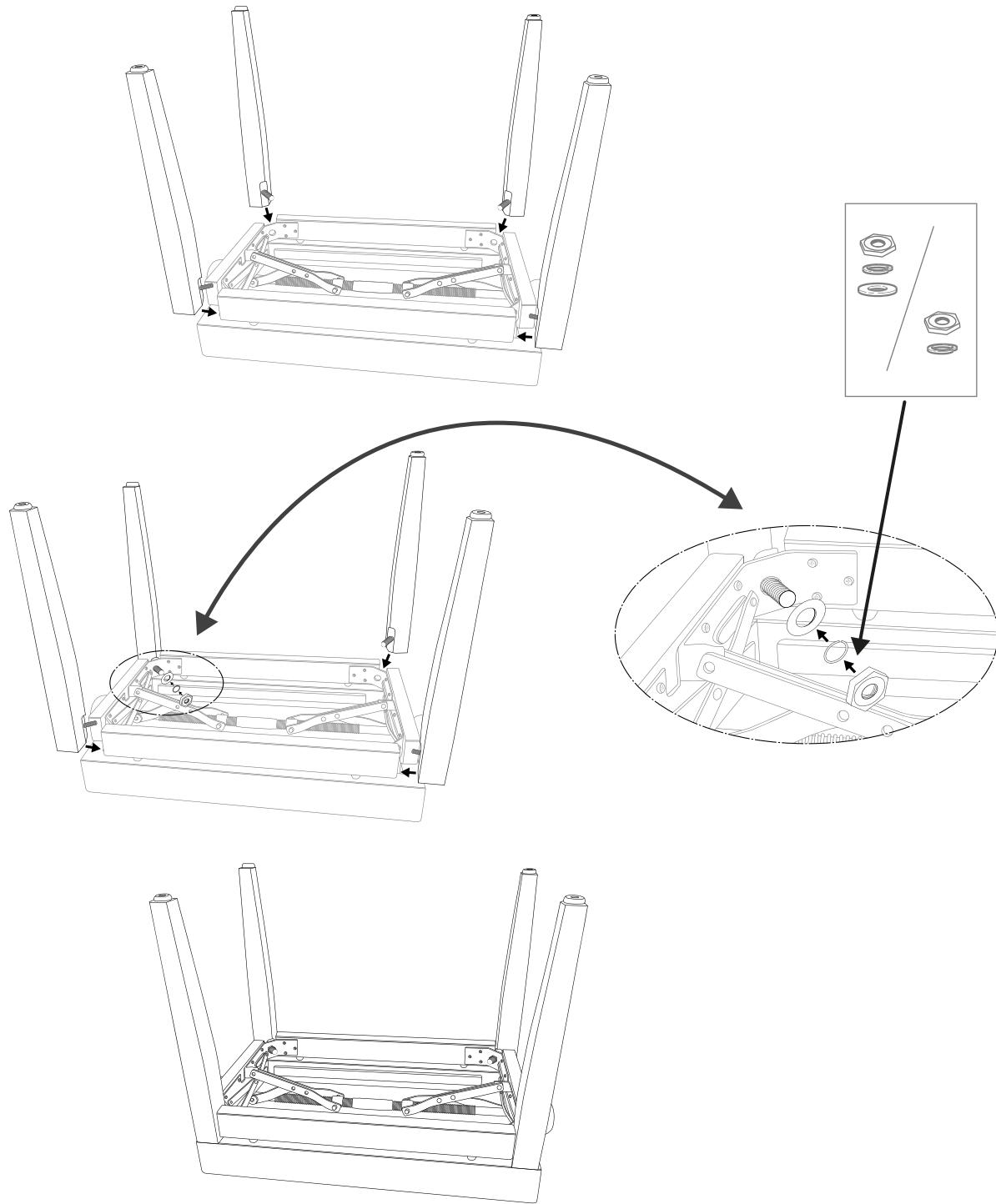
Ziehen Sie die Muttern zunächst leicht an. Stellen Sie die Bank in der gewünschten Position auf den Boden, sodass sie stabil steht.
