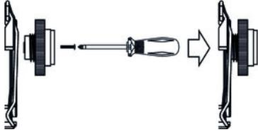
Pour le démontage, levez l'étrier de serrage et sortez l'adaptateur de sabot de flash en le poussant vers le bas.
